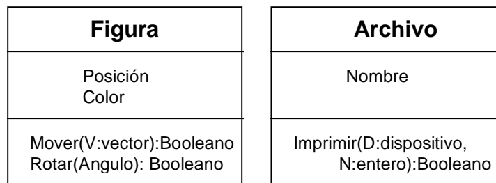
Figura 2.28. Diagrama de clases de Figura y Archivo conteniendo atributos y operaciones con notación extendida.
