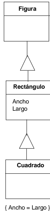
Figura 2.112. Diagrama de clases para una herencia describiendo una superclase Figura , una subclase Rectángulo , y una nueva subclase Cuadrado .
