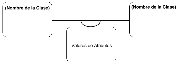
Figura 2.84. Notación para diagrama de objetos con ligas conteniendo valores de atributos de las ligas.
