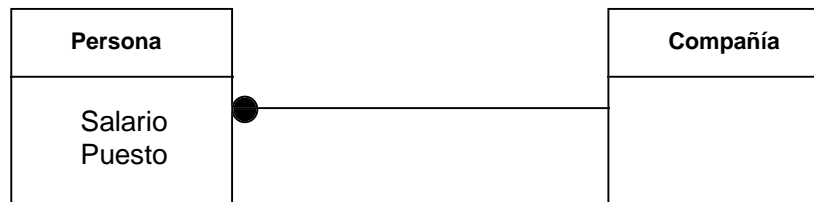
Figura 2.87. Diagrama de clases para Persona y Compañía conteniendo multiplicidad "uno-muchos" y el atributo de asociación salario incluido directamente en la clase Persona .
